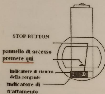
LOCAZIONE DEL PANNELLO DI ACCESSO
